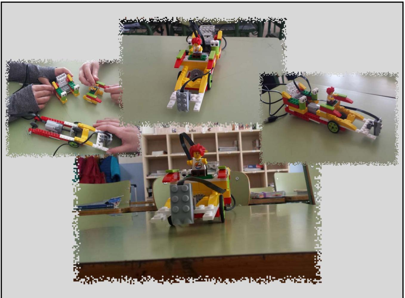
**Equipo de programación del robot:** programación del proyecto para el robot y unión con el robot lego. En este caso la programación del coche es sencilla, utilizando el sensor de proximidad para detectar la caída usando el sensor de inclinación para que el coche se mueva hacia delante, hacia atrás o que se quede quieto
